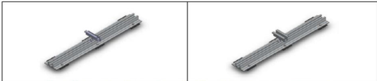
Slika_prikaz karakterističnih vodilica preko 2 ili 3 vala termopanela i/ili trapeznog lima
